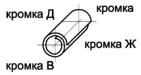
Схема сварачивания полотнища стенки резервуара в рулон
